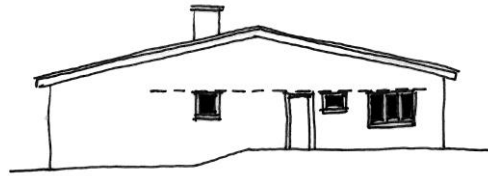
Alignement par le haut des ouvertures
